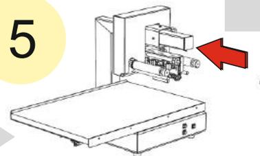
Завинтить стопорную гайку. Замена головки выполнена!
