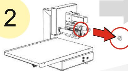
Сдвинуть и снять картридж
