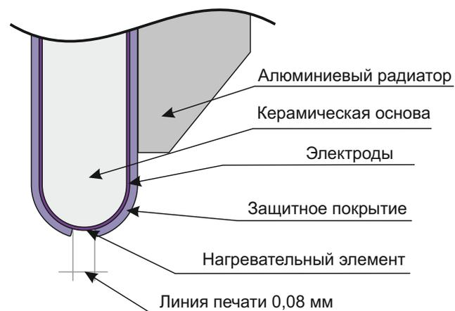
Печатная головка Foil Print 106 представляет из себя керамическую пластину с расположенными на ней термоэлементами. Специальное защитное покрытие локализует нагрев в пределах одного печатного пикселя.
